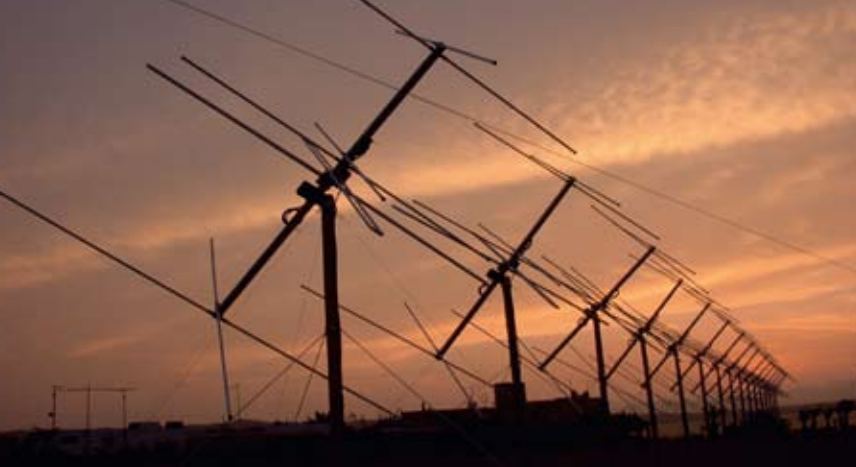
Izquierda: Arreglo de antenas tipo Yagi en la península de Paracas, que forma parte del radar biestático Jicamarca-Paracas, diseñado para medir la densidad de electrones a 100 km de altura en el denominado Electrochorro Ecuatorial, un fenómeno ionosférico que cruza el cielo del Perú. Derecha: Cuatro promociones de Jicamarca reunidas en el 12 Simposio Internacional sobre Aeronomía Ecuatorial en Creta, Grecia. Parados, de izquierda a derecha: Edgardo Pacheco (PUCP - U. Texas), Pablo Reyes (UNI - U. Illinois), Julio Urbina (UNI - Penn State U.), Ronald Woodman (UNI - ROJ), Jorge Chau (UDEP - ROJ), Marco Milla (PUCP - U. Illinois), Elizabeth Silvestre (UNLM - ROJ), Henry Pinedo (UDEP - ROJ). Sentados, de izquierda a derecha: Freddy Galindo (UNI - ROJ), C. Valladares (UNI - Boston College).
